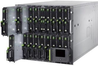
A la différence des 2 autres formats, les serveurs en lames ne peuvent pas fonctionner seuls. Ils ont besoin d'être encastrés dans un châssis. C'est ce châssis qui contiendra les alimentations électriques et les connexions réseaux.
